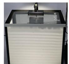
Appareil à assembler pour l'étude de la propagation des ondes dans l'eau. Produit rapide à installer : montage en moins de 5 mn. Stroboscope à LED sur flexible aimanté avec fréquence synchrone / asynchrone. Lecture directe de la fréquence du générateur d'ondes. Réglage de niveau par 4 pieds réglables et niveau à bulle
