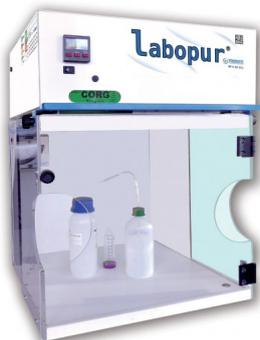
Mini-Hotte à recirculation d'air avec enceinte rigide et passages de bras latéraux. Se place aisément sur une paillasse ou un établi. Dim. extérieures H x L x P (mm) : 605 x 505 x 485 Dim. intérieures H x L x P (mm) : 410 x 455 x 445 Poids : 25 Kg
